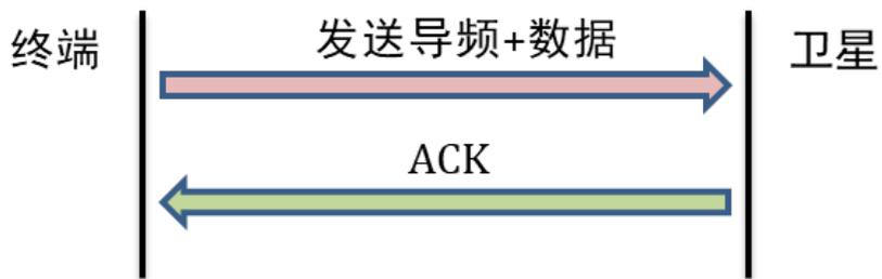
两步免调度随机接入流程
